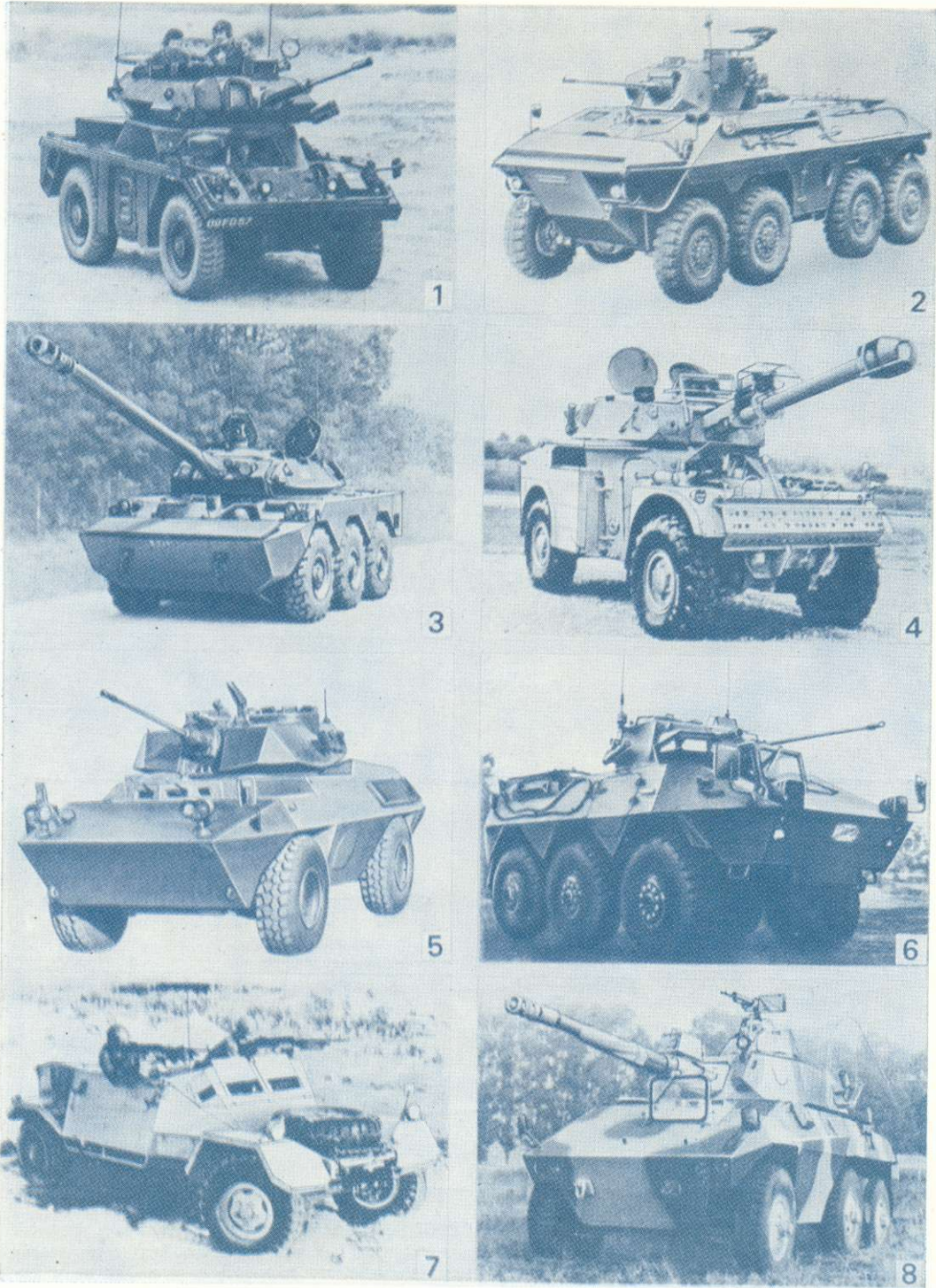
БОЕВЫЕ РАЗВЕДЫВАТЕЛЬНЫЕ МАШИНЫ: 1 — „Фокс“ (Великобритания); 2 — „Лукс“ (ФРГ); 3 — AMX-10RC (Франция); 4 — AML-90 (Франция); 5 — „Фиат“ 6616 (Италия); 6 — тип 88 (Япония); 7 — RBY Mk1 (Израиль); 8 — „Каскавел“ (Бразилия).
